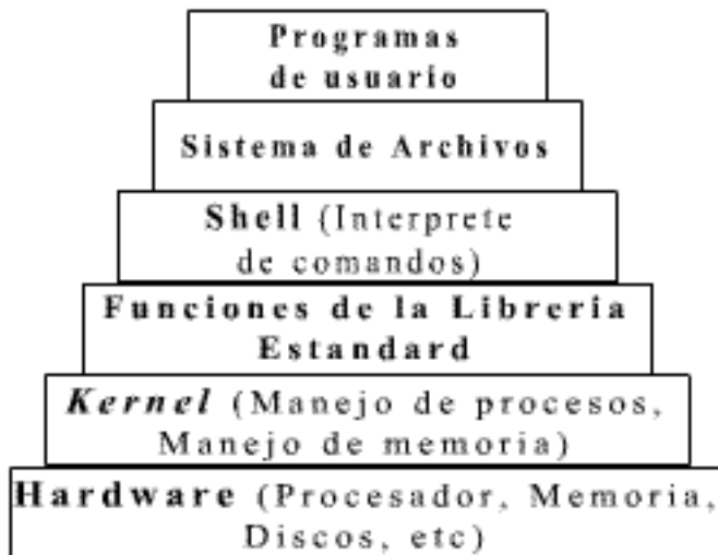
Figura 2.2: Modelo de capas del sistema operativo UNIX®
